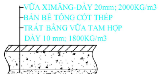
HÌNH 2. CÁC LỚP CẤU TẠO SÀN
