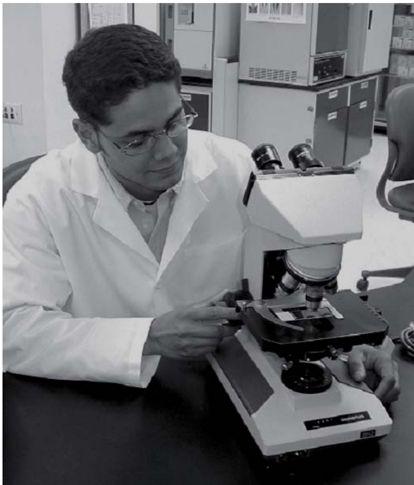
Hình 3. Khi chỉnh kính hiển vi, người kỹ thuật viên quan sát vật kính một cách cẩn thận để tránh làm vỡ tiêu bản và làm hỏng vật kính của kính hiển vi
